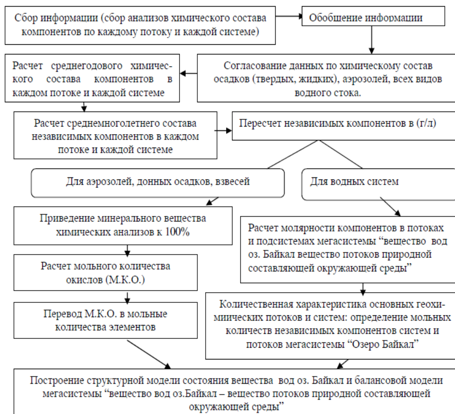
Рисунок – Схема методики расчета химического состава независимых компонентов для физико-химической модели “Озеро Байкал”
